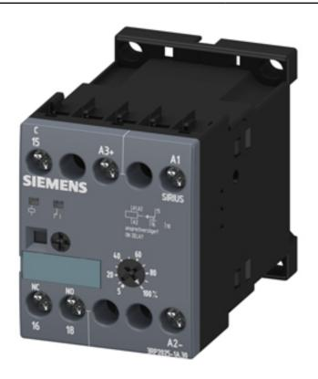
SOLID-STATE TIME-DELAY RELAY ON-DELAY 1 CHANGEOVER CONTACT AC/DC 24V, AC 200 TO 240V 0.05 S TO 100H WIDTH 45MM SCREW TERMINALS
