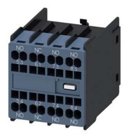
AUX.SWITCH BLOCK,FRONT,3NO+1NC, CURR.PATH: 1NO, 1NC, 1NO, 1NO, FOR CONTACTOR RELAYS, SZ S00, SPRING-LOADED TERMINAL 53 / 54,61 / 62,73 /74,83 / 84
