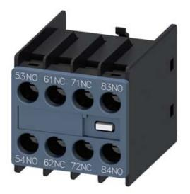
AUX.SWITCH BLOCK,FRONT,2NO+2NC, CURR.PATH: 1NO, 1NC, 1NC, 1NO, FOR CONTACTOR RELAYS, SZ S00, SCREW TERMINAL 53 / 54,61 / 62,71 / 72,83 / 84
