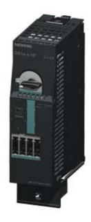
DS1E-X FOR ET200S HIGH FEATURE DIRECT STARTER SETTING RANGE 2.4...8A MECHANICAL SWITCHING ELECTRONIC PROTECTION AC-3/TO 3KW/400V EXPANDABLE FOR BRAKE CONTROL MODULE 2DI MODULE 2DI MODULE MOTORSTARTER ES SIGNAL FROM CIRCUIT-BREAKER PARAMETERIZABLE DPV 1 CAPABLE PROFIENERGY CAPABLE ON PN
