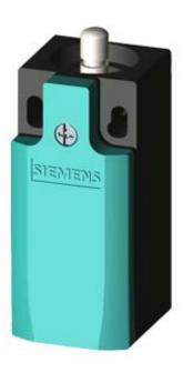
SIRIUS POSITION SWITCH; PLASTIC ENCLOSURE ACC. TO EN50047, 31MM DEVICE CONNECTION 1X(M20X1.5); 2NO/1NC SLOW-ACTION CONTACTS ROUNDED PLUNGER, FORM B, WITH TEFLON PLUNGER
