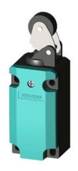
SIRUS POSITION SWITCH PLASTIC ENCLOSURE 40MM TO EN50041 DEVICE CONNECTION 1X (M20X1.5) 2NO/1NC SLOW-ACTION CONTACTS METAL ROLLER LEVER AND PLASTIC ROLLER 22MM
