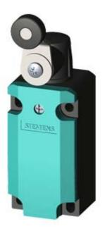
SIRIUS POSITION SWITCH PLASTIC ENCLOSURE 40MM, TWIST LEVER, TO EN50041, DEVICE CONNECTION 1X (M20X1.5) 1NO/1NC SLOW-ACTION CONTACTS PART-TURN ACTUATOR RIGHT/LEFT ADJUSTABLE, METAL LEVER 27MM LONG AND PLASTIC ROLLER 19MM
