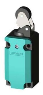
SIRIUS POSITION SWITCH PLASTIC ENCLOSURE 40MM, TO EN50041 DEVICE CONNECTION 1X (M20X1.5) 1NO/1NC SNAP-ACTION CONTACTS METAL ROLLER LEVER AND PLASTIC ROLLER 22MM
