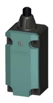
SIRIUS POSITION SWITCH PLASTIC ENCLOSURE 40MM, TO EN50041 DEVICE CONNECTION 1X (M20X1.5) 1NO/1NC SNAP-ACTION CONTACTS ROUNDED PLUNGER OF PLASTIC
