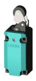
SIRUS POSITION SWITCH PLASTIC ENCLOSURE 40MM TO EN50041 DEVICE CONNECTION 1X (M20X1.5) 1NO/1NC SLOW-ACTION CONTACTS METAL ROLLER LEVER AND PLASTIC ROLLER 22MM
