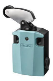
SIRIUS POSITION SWITCH METAL ENCLOSURE 56MM WIDE DEVICE CONNECTION 3X (M20X1.5) 1NO/1NC SNAP-ACTION CONTACTS ANGULAR METAL ROLLER LEVER AND PLASTIC ROLLER 22MM
