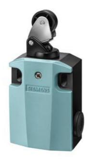
SIRIUS POSITION SWITCH METAL ENCLOSURE 56MM WIDE DEVICE CONNECTION 3X (M20X1.5) 1NO/1NC SNAP-ACTION CONTACTS METAL ROLLER LEVER AND PLASTIC ROLLER 22MM
