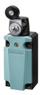
SIRIUS POSITION SWITCH METAL ENCLOSURE 40MM TO EN50041 DEVICE CONNECTION 1X (M20X1.5) 1NO/ 2NC SLOW-ACTION CONTACTS ROTARY ACTUATOR RIGHT/LEFT ADJUSTABLE, METAL LEVER 27MM LONG AND PLASTIC ROLLER 19MM
