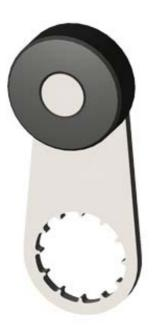
TWIST LEVER FOR POSITION SWITCH 3SE51 /52 METAL LEVER 30MM LONG WITH PLASTIC ROLLER 19MM, CAN BE MOUNTED INVERSELY (TURNED BY 180 DEGREES, REAR OF LEVER)
